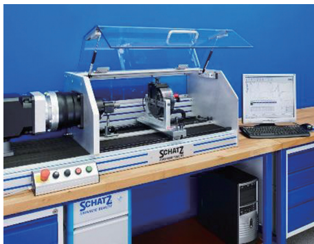
图2 多功能螺栓紧固分析系统 Fig.2 Multi function screw fastening analysis system
